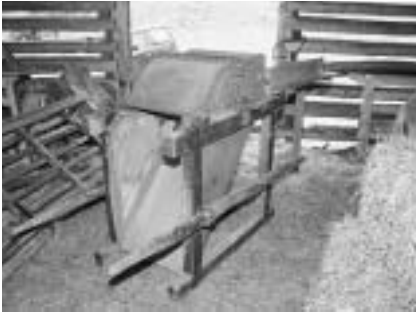
Dreschmaschine von vorn; Gestell mit Gleite, überdeckte Walze, eingesteckte Tragholmen und hinten Garbentisch.
