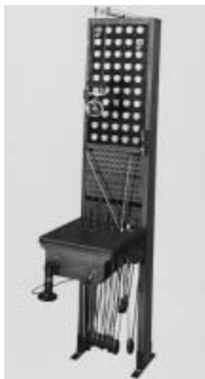
Telefonhandzentrale (LB-Klappenschrank Hasler) 1890
